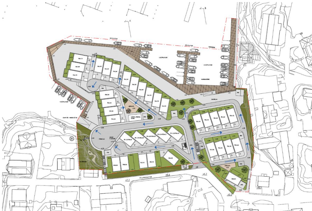
Figur 17. Karta visandes föreslagen höjdsättning av marken och färdigt golv i byggnader samt vattnets avrinningsriktningar (blå pilar).
